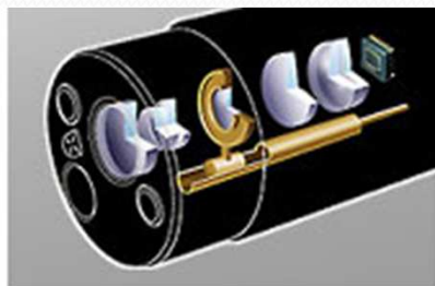
<拡大内視鏡の先端部の構造>
